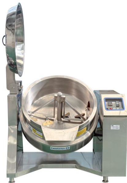
Рис №3 Модель – XDC-80. Внешний вид модели и тип месильного органа
