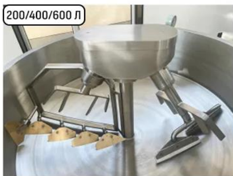
Рис №4 Модель – XDC-80X. Внешний вид модели и тип месильного органа
